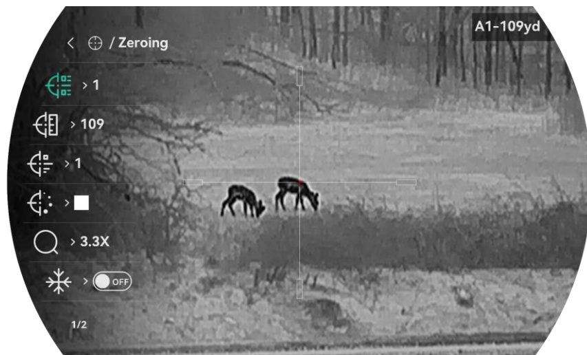
Рисунок 4-1 Використання візирного хреста
